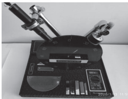
3-расм. Қурилмада намуна сиртидан қайтган нурнинг қисқа туташув токини қуёш элементи ёрдамида ўлчаш
